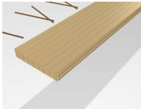
3. Durch den Feuchtigkeitsausgleich der trockenen Hartholzdübel mit den umliegenden Holzlamellen quellen diese auf und vermeiden so ein Schwinden des fertigen Elements.
