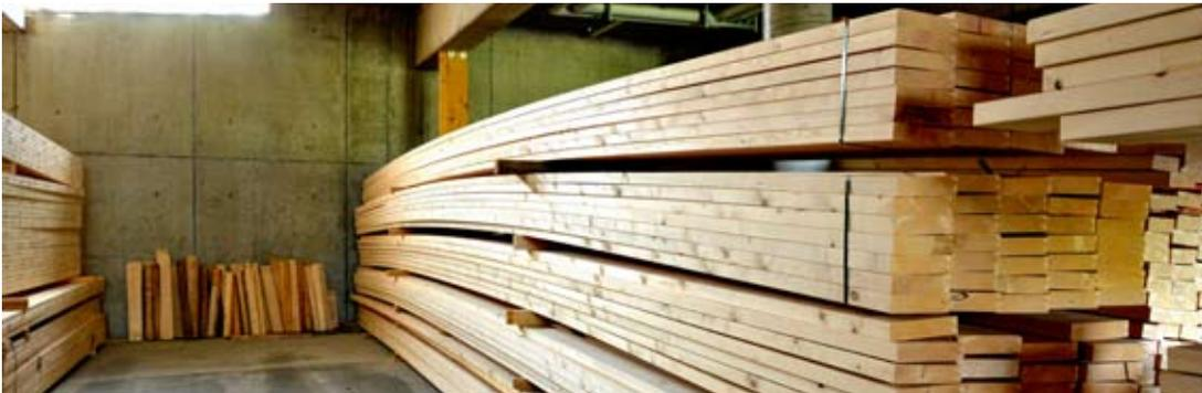
Ausgangsprodukt in unserer Produktionslinie sind Holzbretter geschnitten im Rift- oder Halbribschnitt. Diese werden von uns beginnend von der Keilzinkung, über die Verdübelung zum DD-Element, weiter zur CNC-Abbundanlage sowie Handabbund, bis hin zur Montage durch unser eingespieltes Team verarbeitet.
